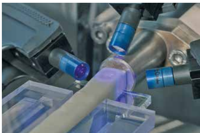
Abb. 2: Neues, automatisiertes Extrusionsverfahren. Hier: Belichtung zur Vor- oder Aushärtung des Kompositstrangs. © K. Selsam, Fraunhofer ISC
