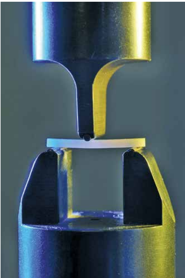
Abb. 5: Umfassende Materialcharakterisierung und Qualitätskontrolle. Drei-Punkt-Biegeversuch zur mechanischen Charakterisierung (Festigkeit/E-Modul) von dentalen Materialien. © K. Dobberke für Fraunhofer ISC
