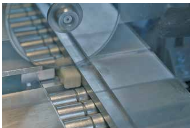
Abb. 3: Zuschneiden des Kompositstrangs zu einzelnen CAD/CAM-Blöcken. © K. Selsam, Fraunhofer ISC
