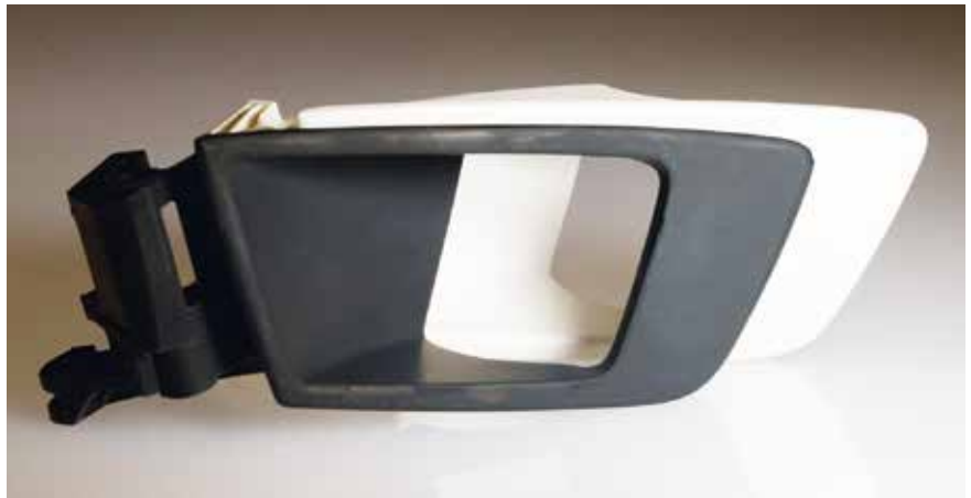
Kunststoffgriffe mit leitfähiger Hybridpolymerschicht (schwarz) oder unbeschichtet (weiß)
