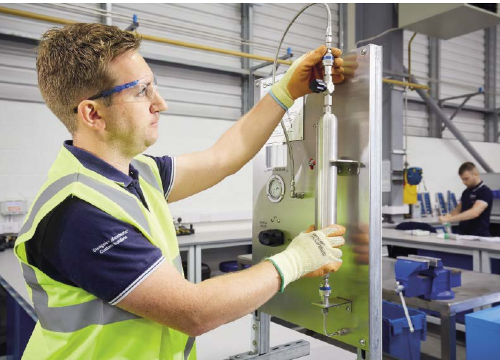
Bei der Stichprobenahme kommen zur Entnahme druckbeaufschlagter Gase oder Flüssigkeiten in der Regel Zylinder zum Einsatz.
